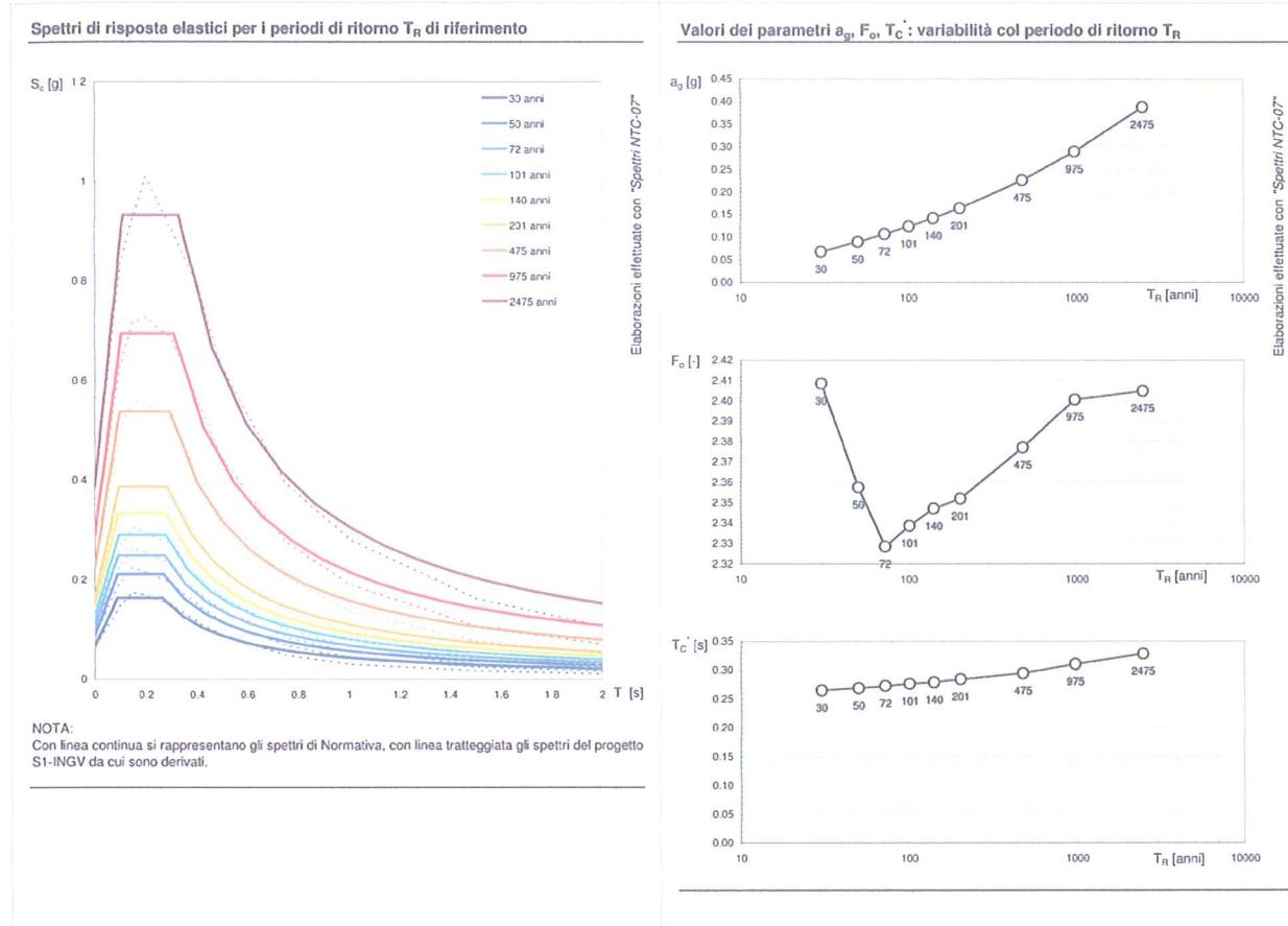
Sopra a sx sono riportati gli spettri di risposta elastici delle NTC08 su sito pianeggiante e roccioso (suolo A e ST = 1) mentre le linee tratteggiate rappresentano gli spettri a pericolosità uniforme del progetto. Nei grafici in destra riportati viene indicata la variabilità dei parametri  $a_g$ ,  $F_0$  e  $T_C^*$  rispetto ai vari tempi di ritorno. I valori sono riferiti in condizioni di campo libero e bedrock sismico affiorante.
