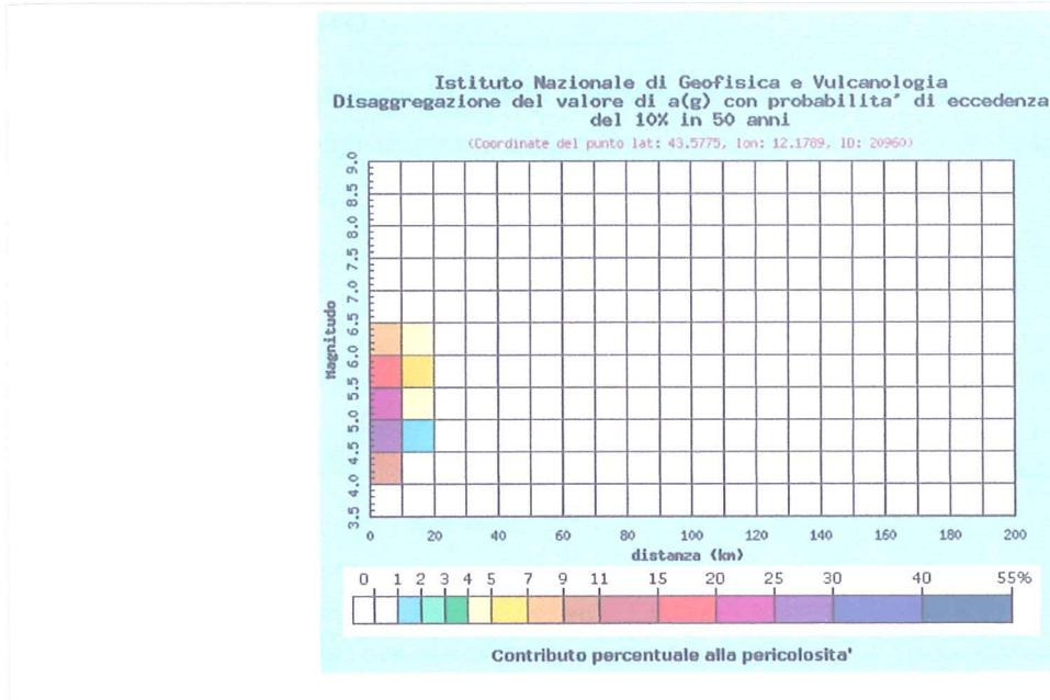
Dal grafico si ricava che per un range compreso tra 6,0 e 6,5 di Magnitudo, entro una distanza di 10 km, sussiste un 7-9% massimo probabilistico che si verifichino sismi di tale intensità. I parametri sono relativi alla probabilità di superamento del 10% in 50 anni del valore del PGA. I valori medi sono pari a magnitudo 5.26 per una distanza di 6.40 km.
